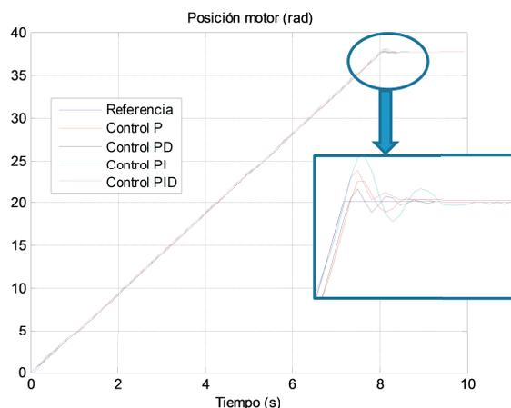
Figura 6: Respuesta control de posición motores Lego.
