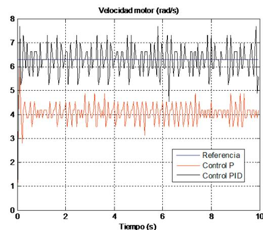
Figura 7: Respuesta control de velocidad motores Lego.
