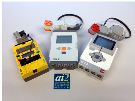
Figura 1: Unidades de control RCX, NXT y EV3 y sus respectivos actuadores eléctricos de Lego Minstorms desarrolladas.
