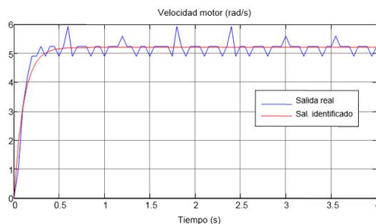
Figura 5: Respuesta a un escalón en velocidad del sistema real y del identificado.
