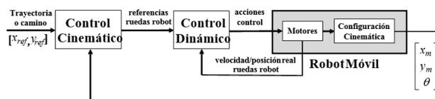
Figura 10: Arquitectura control cinemático de robots móviles.
