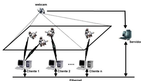
Figura 13: Arquitectura cliente-servidor utilizada con los Lego.
