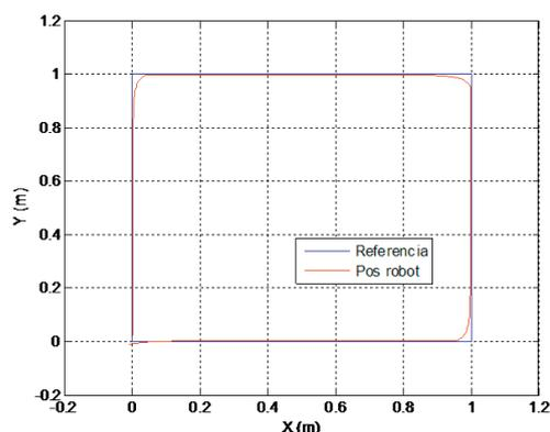
Figura 11: Respuesta control cinemático robot diferencial Lego.
